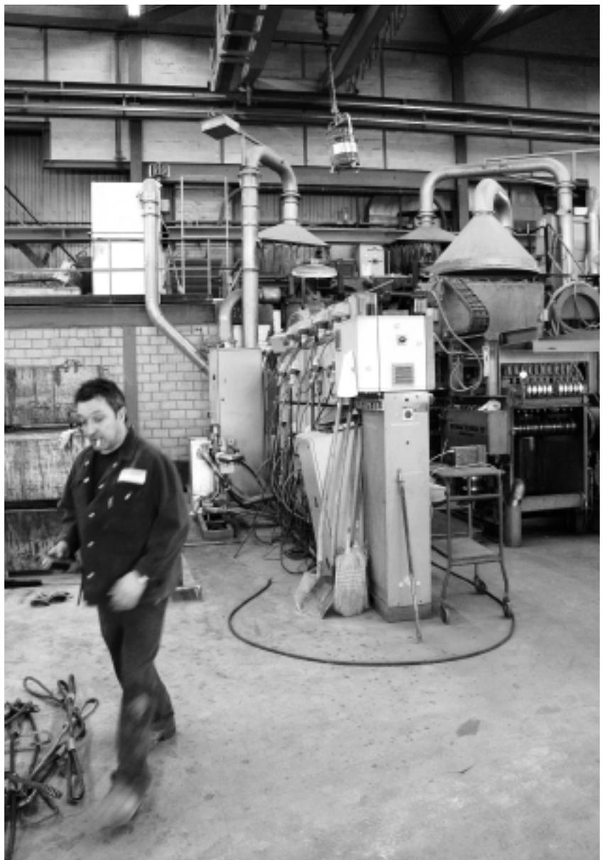
Im Ofen wird der Rohstoff Kupfer eingeschmolzen und anschliessend zu Zylindern gegossen.
