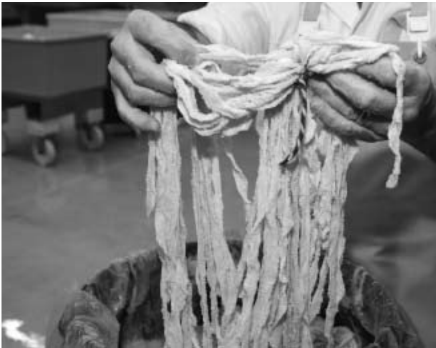
Eingesalzene Därme bei der Max Ramp AG in Liestal. Mario Navarro bläst die künftigen Cervelathäute auf, um den Durchmesser zu ermitteln.
