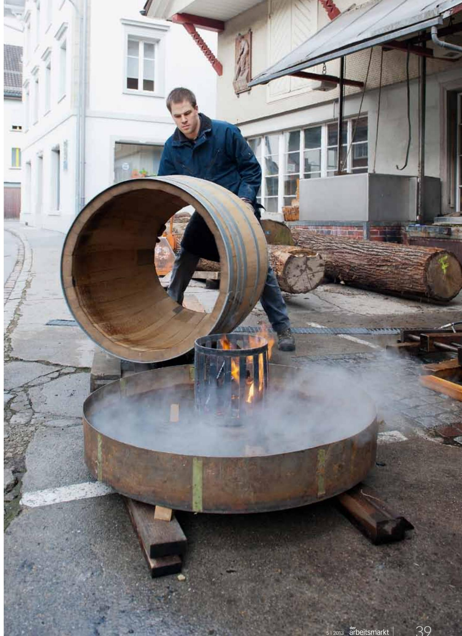
**Toasten** Nachdem der Küfer die vier Reifen auf der unteren Seite angebracht hat, trocknet er das Fass und stellt es erneut über das Feuer. Während einer halben bis zwei Stunden wird dieses getoastet. Das beeinflusst das Aroma des Weines. Zum Schluss bringt der Küfer den Fassboden an, hobelt und schleift das Fass für den letzten Schliff und bohrt das Spundloch für den Weinausgang. Die fertige Barrique wiegt fünfzig bis sechzig Kilogramm und kostet 1710 Franken.
