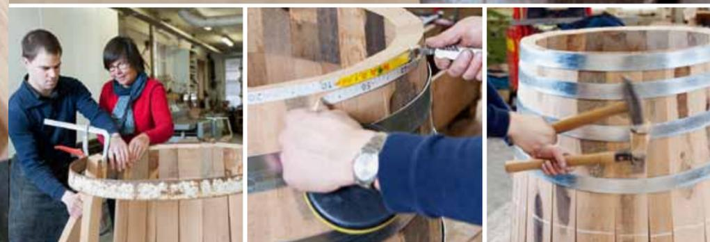
**Aufsetzen** Die 500 Liter fassende Barrique nimmt Formen an. Die Fassreifen aus feuerverzinktem Bandstahl muss der Küfer zuerst auf die richtige Länge zuschneiden, biegen und mit Nieten verbinden. Mithilfe seiner Mutter ordnet der Küfer die Dauben an und hämmert anschliessend vier Reifen ans Holz, bis sie festsitzen.
