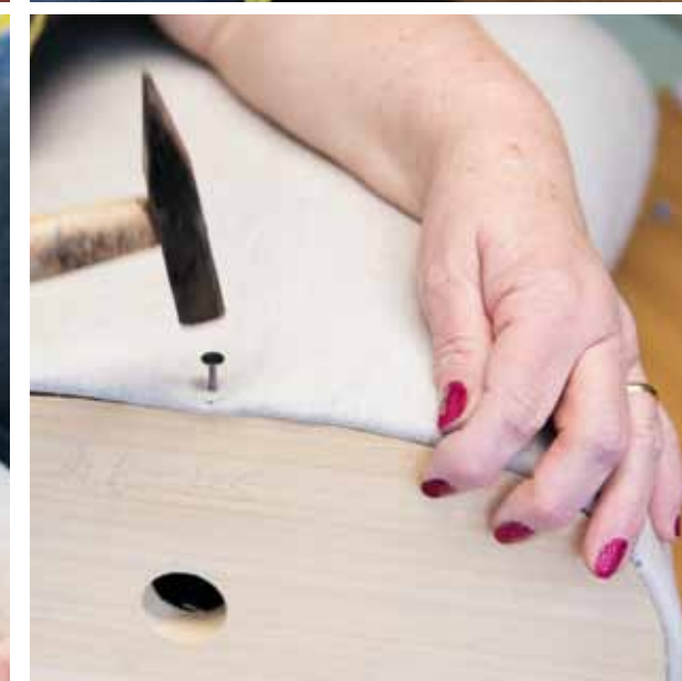
Rita Belgio umhüllt den nackten Kartor-torso mit einer Watteschicht und über-zieht ihn mit Leinen. Mit Stecknadeln spannt sie den Stoff eng um den Torso und misst den Umfang. Stimmt er, näht sie die Enden zusammen. Die restliche Watte schneidet sie ab und klebt die Stoffenden nach innen fest. Am Schluss setzt sie den Boden wieder ein und befestigt ihn mit Nägeln.
