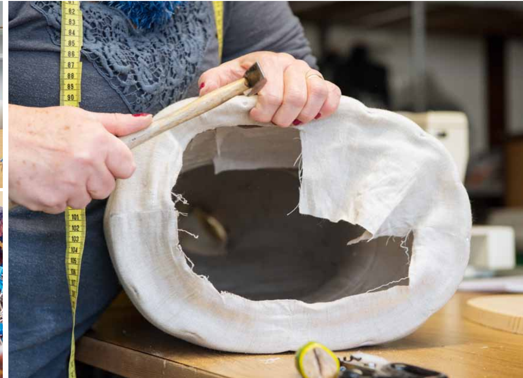
Rita Belgio umhüllt den nackten Kartor-torso mit einer Watteschicht und über-zieht ihn mit Leinen. Mit Stecknadeln spannt sie den Stoff eng um den Torso und misst den Umfang. Stimmt er, näht sie die Enden zusammen. Die restliche Watte schneidet sie ab und klebt die Stoffenden nach innen fest. Am Schluss setzt sie den Boden wieder ein und befestigt ihn mit Nägeln.
