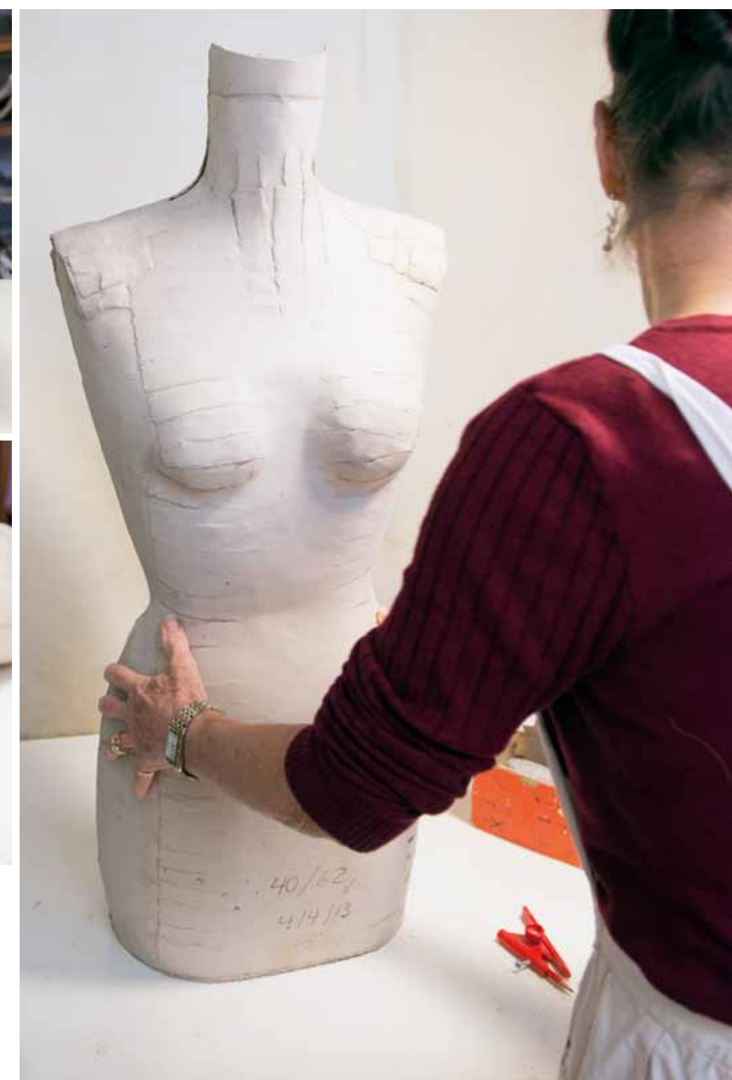
Firmenbesitzerin Marianne Burch sägt den gekennzeichneten Abschluss ab und schleift die Kanten der Büste mit einer Feile, damit sie gerade steht. Zum Schluss macht die gelernte Kauffrau den Feinschliff mit der Maschine und gleicht damit die Unebenheiten aus.
