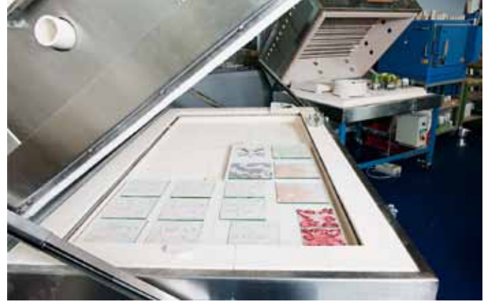
Bei 720 bis 820 Grad Celsius erhalten die Glaskunstwerke im Brennofen ihre endgültigen Formen und Farben.
